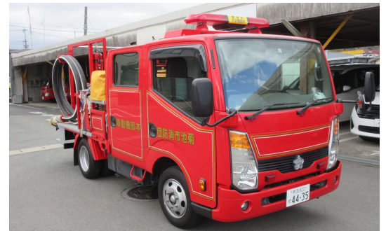
小型動力ポンプ積載車
