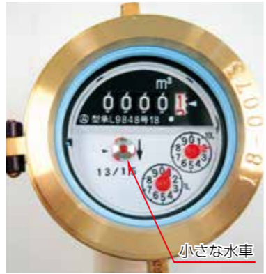
水道メーター器
