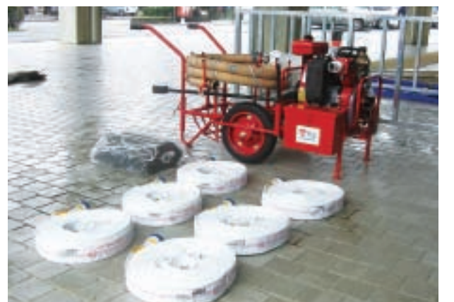
購入したホースや軽可搬消防ポンプ
