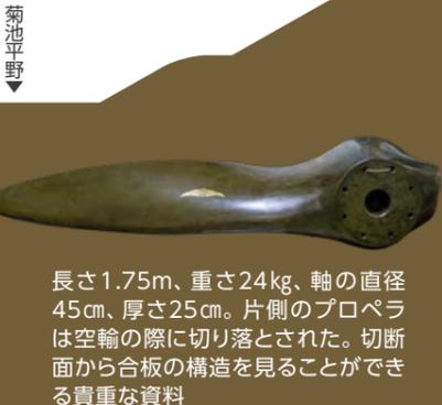
長さ1.75m、重さ24kg、軸の直径45cm、厚さ25cm。片側のプロペラは空輸の際に切り落とされた。切断面から合板の構造を見ることができ貴重な資料
