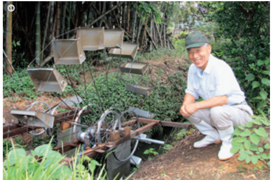
①2代目となる水車 ②水力発電で発光する防犯灯 ③自転車の車輪や、発電用のダイナモ、油の斗缶など、材料のほとんどを廃材で作成。「電気溶接が難しかった」と苦労もありました
