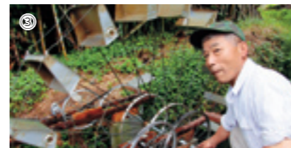
①2代目となる水車 ②水力発電で発光する防犯灯 ③自転車の車輪や、発電用のダイナモ、油の斗缶など、材料のほとんどを廃材で作成。「電気溶接が難しかった」と苦労もありました
