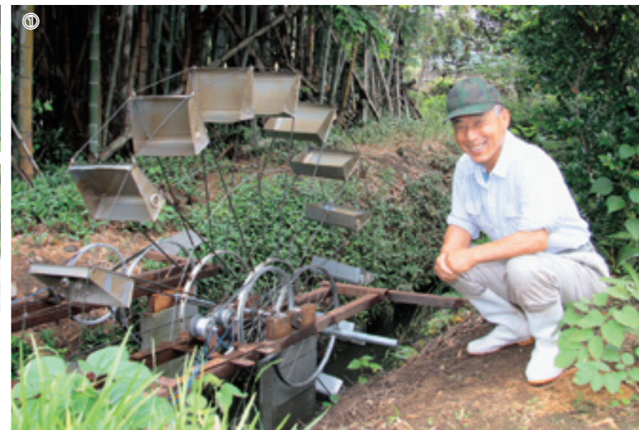
①2代目となる水車 ②水力発電で発光する防犯灯 ③自転車の車輪や、発電用のダイナモ、油の斗缶など、材料のほとんどを廃材で作成。「電気溶接が難しかった」と苦労もありました
