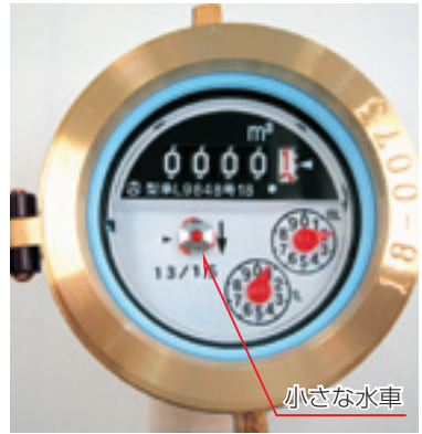
水道メーター器
