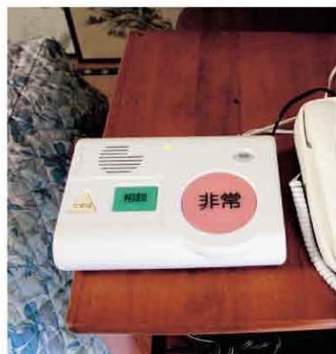
緊急通報装置
