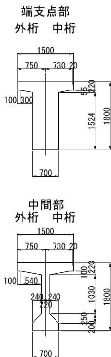
主桁断面図 S=1/50
