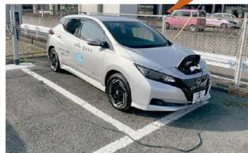
西区役所に配置された電気自動車（蓄電能力40kWh）と公用車用普通充電設備（写真左奥）
