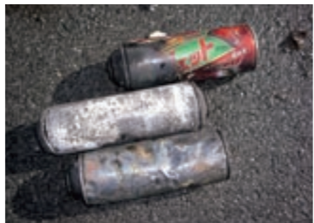
ガス抜き（穴あき）がしてなかったため、破裂し引火したガスボンベ（スプレー缶）
